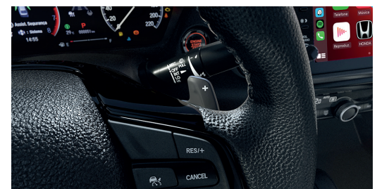
Transmisión CVT con modo de conducción sport con paddle shift
